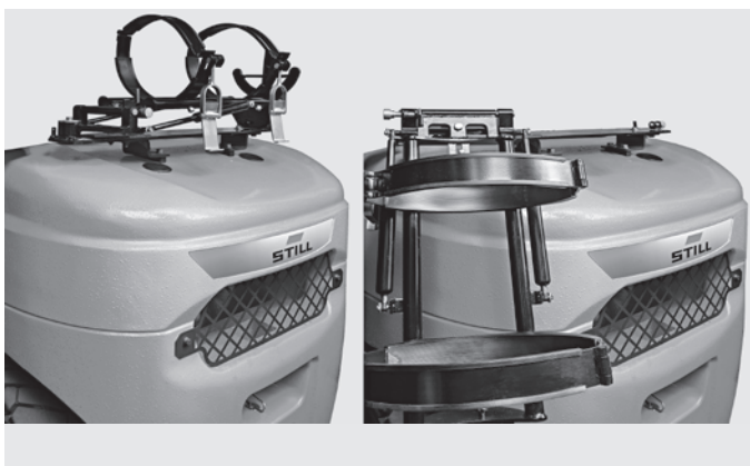
Le bombole di gas sono veloci e facili da sostituire grazie al supporto della bombola ergonomico con meccanismo orientabile e ripiegabile
