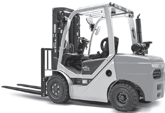
L'RCD/RCG 25-35 è un robusto carrello versatile ad alte prestazioni nella classe di peso da 2,5 a 3,5 tonnellate
