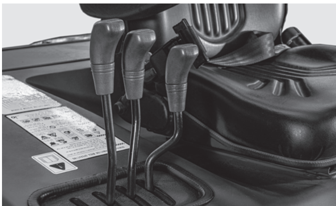
I comandi multileva offrono all'operatore il pieno controllo durante l'uso del sistema di sollevamento idraulico
