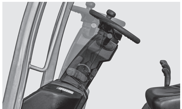
Il piantone dello sterzo regolabile in continuo consente all'operatore di selezionare la posizione di guida più confortevole
